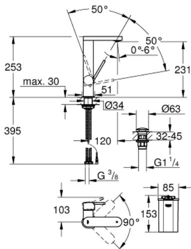
23 959 003 **GROHE PLUS MITIGEUR MONOCOMMANDE LAVABO 1/2" AVEC AFFICHAGE DE LA TEMPÉRATURE - TAILLE L**
